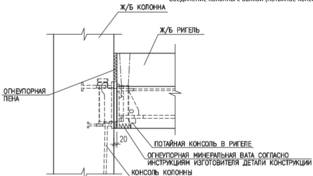
Рисунок 5. Соединение колонны с балкой (потайное консольное соединение)
